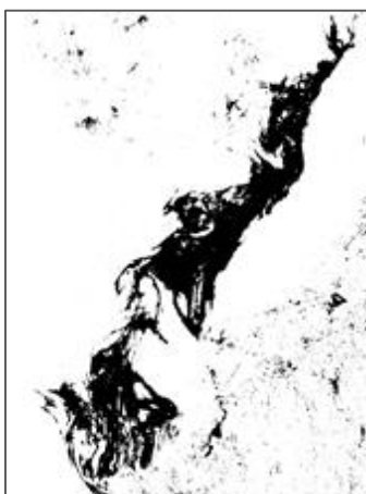
図-2.2 RADARSAT SAR 画像(1997年1月12日)を利用した流出油分布図事故の解析結果(Arvelyna and Oshima, 2002) 4) 図-2.3 1月12日ナホトカ号油流出流出油分布図(福井県環境科学センター) 5)
